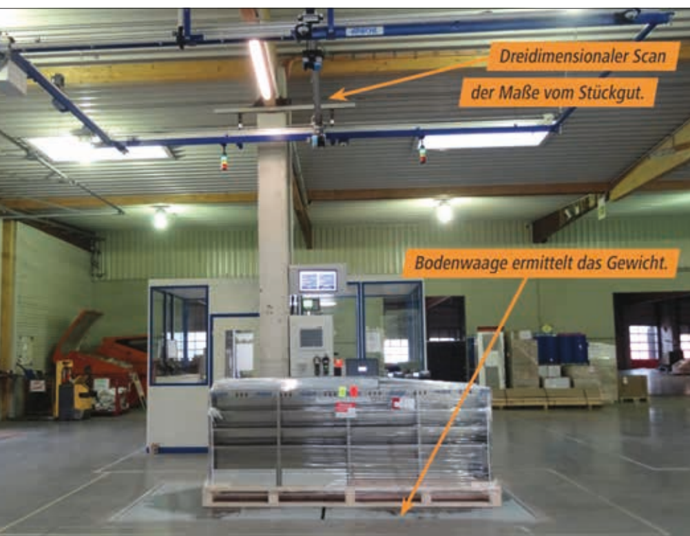
Der 3D-Scanner „Apache“ vermisst Frachtgut automatisch auf Höhe, Länge, Breite oder Gewicht.
